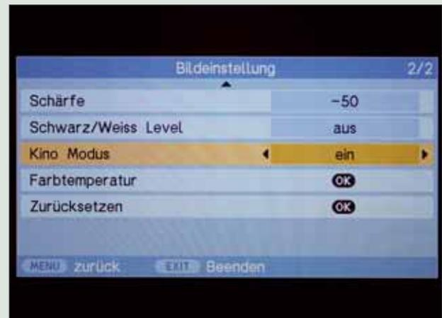
Nur bei aktiviertem Film-Modus ist bei Toshiba's Gerät kein Pull-Down-Ruckeln von 24p-Signalen zu sehen. Falls der Filmmodus nicht aktiviert werden kann, muss erst das Bildformat auf die unskalierte Darstellung umgeschaltet werden.
