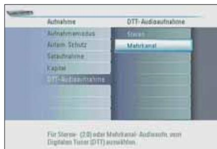
Wird der DVB-T-Tuner genutzt und soll für Mehrkanalaufnahmen erhalten, muss im Aufnahmemenu bei „DTT-Aufnahme“ „Mehrkanal“ aktiviert werden
