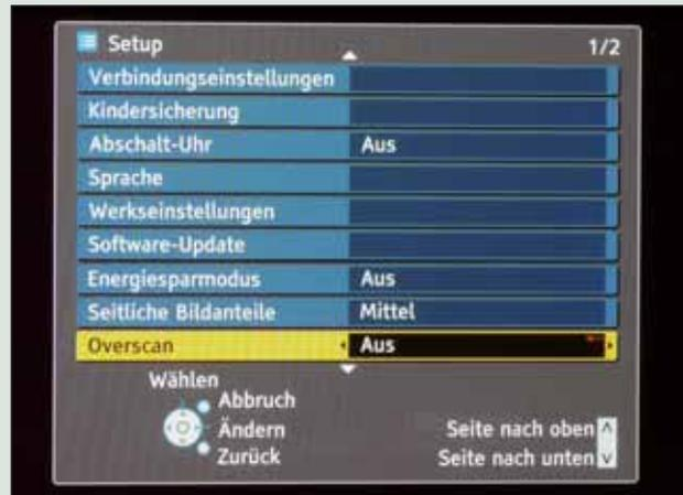
Nur mit deaktiviertem Overscan stellen FHD-Geräte 1080i/p pixelgenau dar, ohne es nochmals zu skalieren. Bei Panasonic befindet sich die Umschaltung im Setup-Menü, bei anderen Geräten im Bildmenü oder bei der Formatusschaltung.
